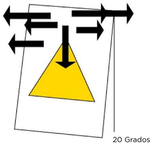
El aire se atrapa fácilmente entre los superficies del adhesivo y el letrero. Un instalador de gráficos que deja una abertura cerca de la escobilla de goma, va ver que la posibilidad del atrapamiento del aire se minimiza.
