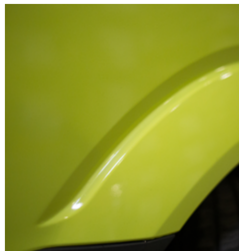
Pojazd oklejony folią SLX™ Cast Wrap z laminatem Series 3270 przez firmę OC Wraps
